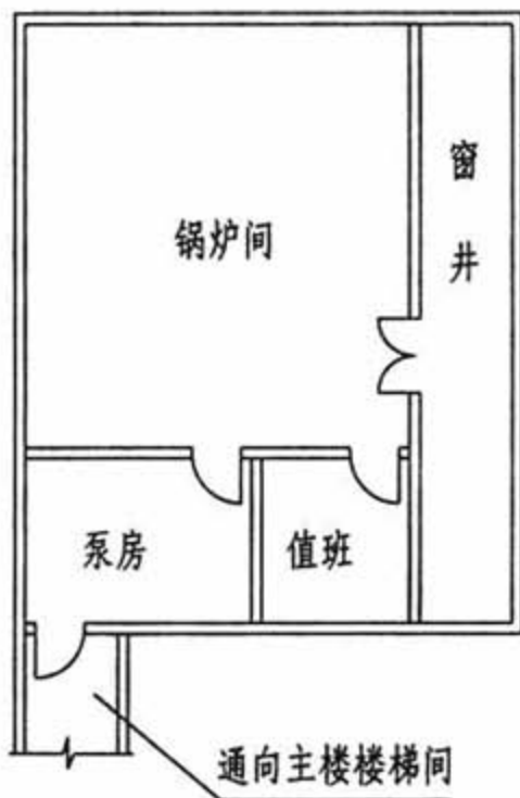
地下独立锅炉房一侧贴邻主楼
