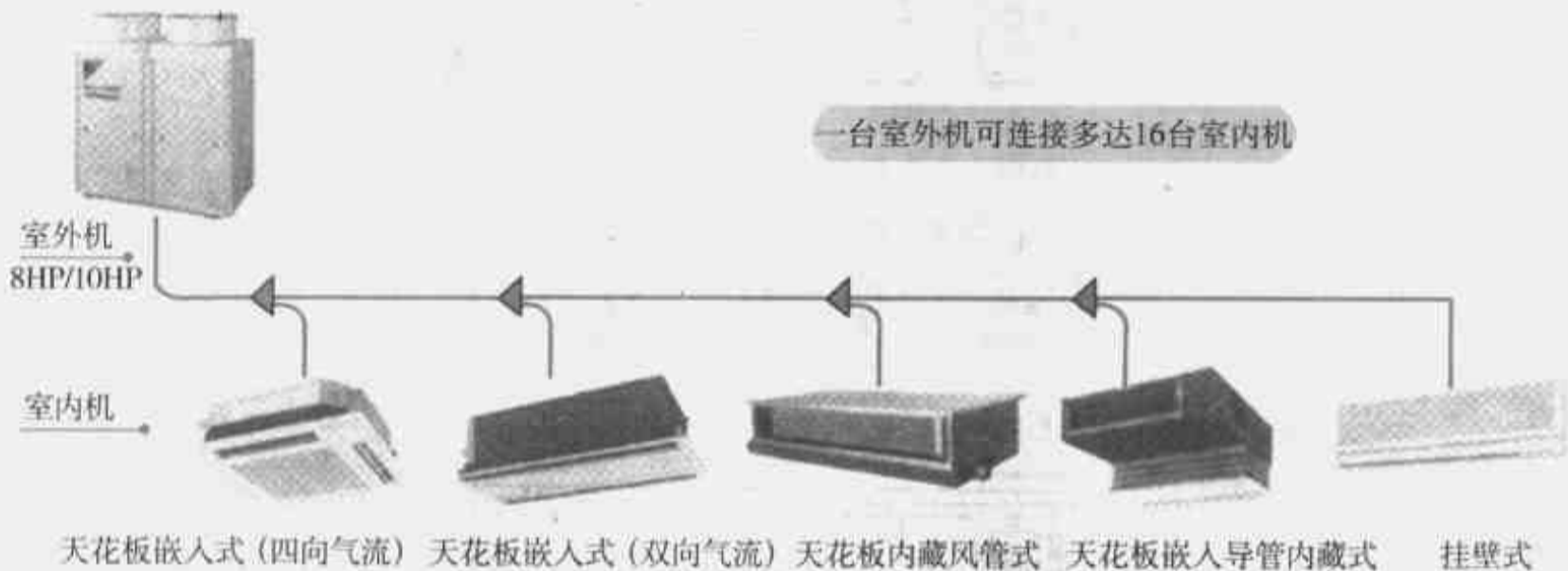
图 4-52 VRV 系统形式示意图
