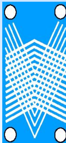
H + L = M 型通道水流示意 特点：K中等，阻力中等
