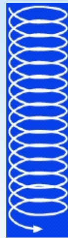
H + L = M 型通道水流示意 特点：K中等，阻力中等
